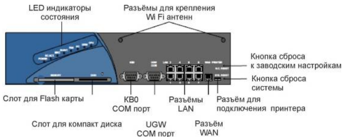
Рис. 12 Лицевая панель основного блока УПАТС Коралл-Р200
