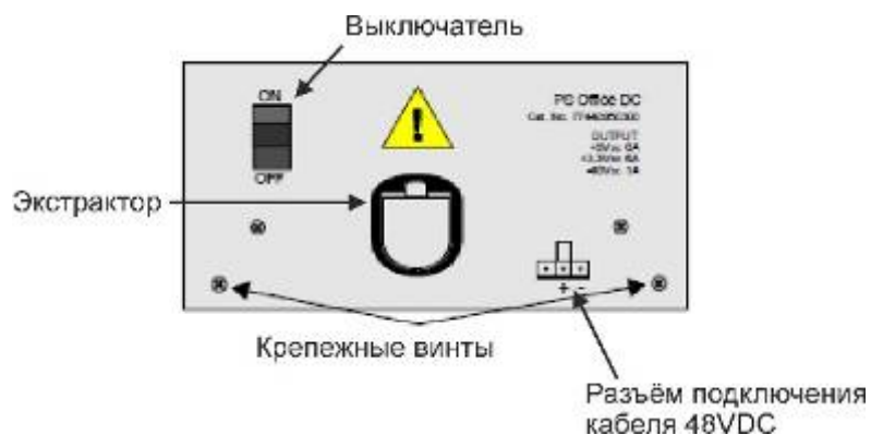
Рис. 15. Вид задней панели Коралл-Р200 с установленным источником питания 48В
