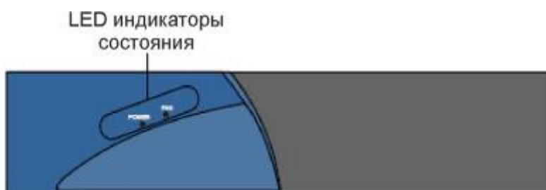
Рис. 13 Лицевая панель расширительного блока Коралл-Р 200Exp
